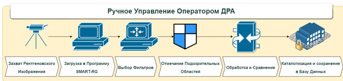
Рис. 5. Алгоритм ручной интерпретации рентгенограмм
