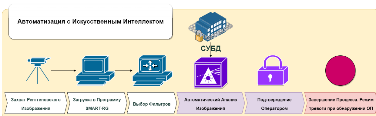
Рис. 6. Алгоритм автоматизированного анализа рентгенограмм
