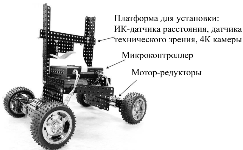
Рис. 2. Активное роботизированное средство безопасности
